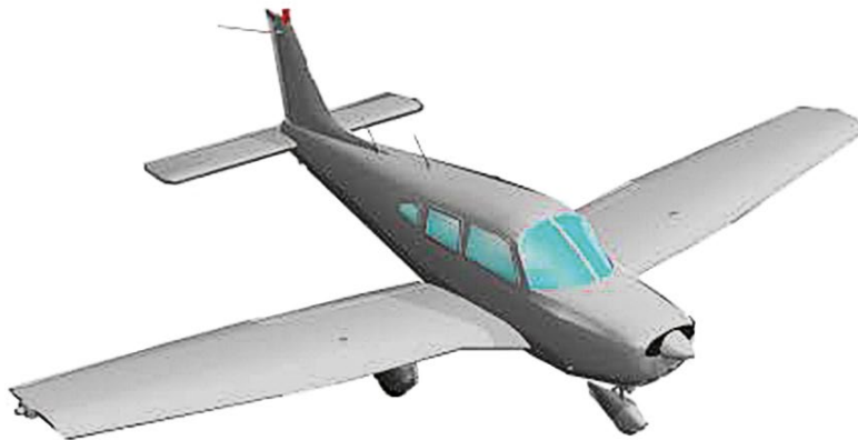
Ailes basses construction métallique
